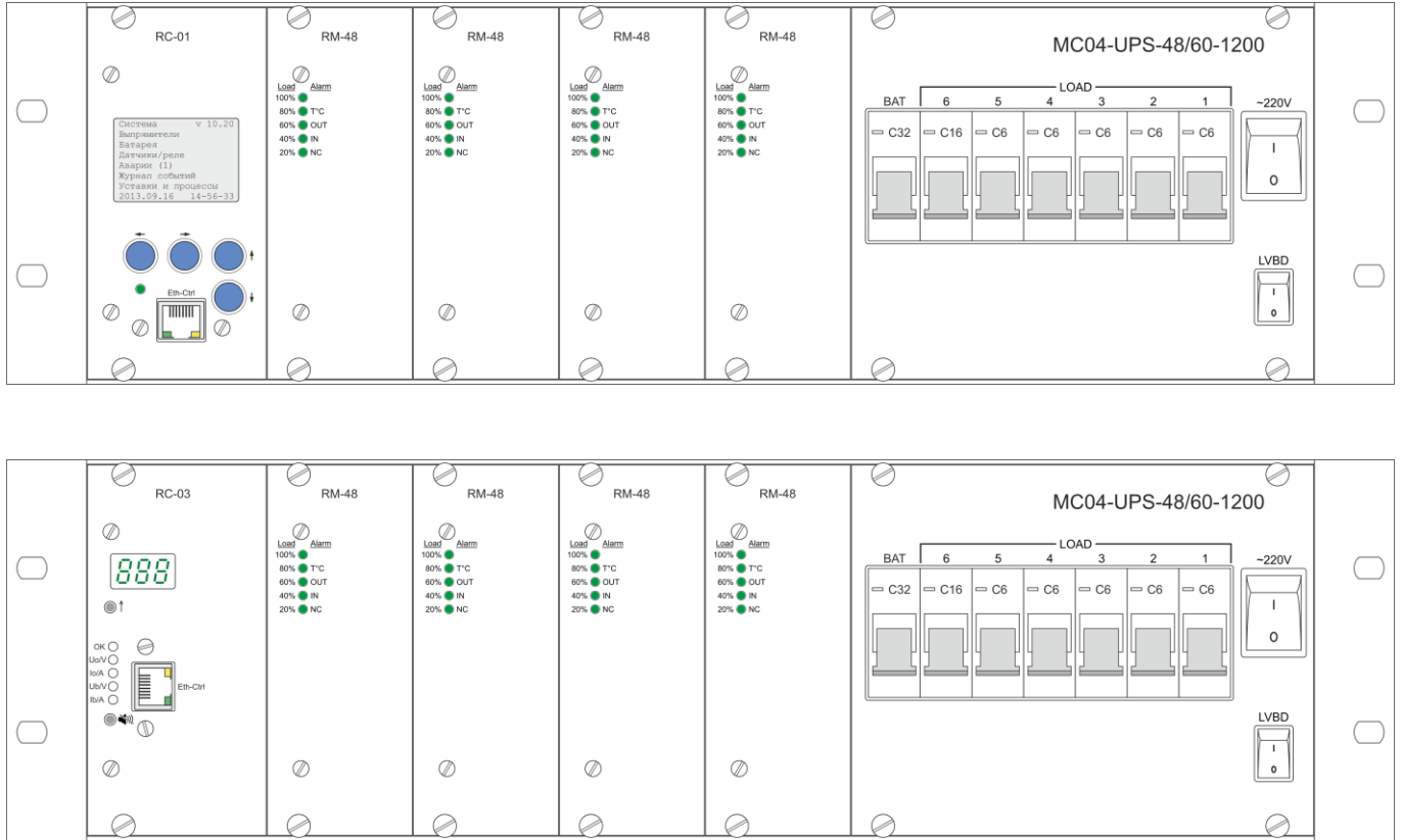
Рис.1. Лицевая сторона блока MC04-UPS-48/60-1200 с модулями управления RC-01 и RC-03.
